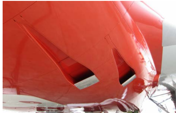
FIGURE 6.26 – Les entrées d'air du circuit RAM au caisson de voilure d'un Boeing 747-8I.
