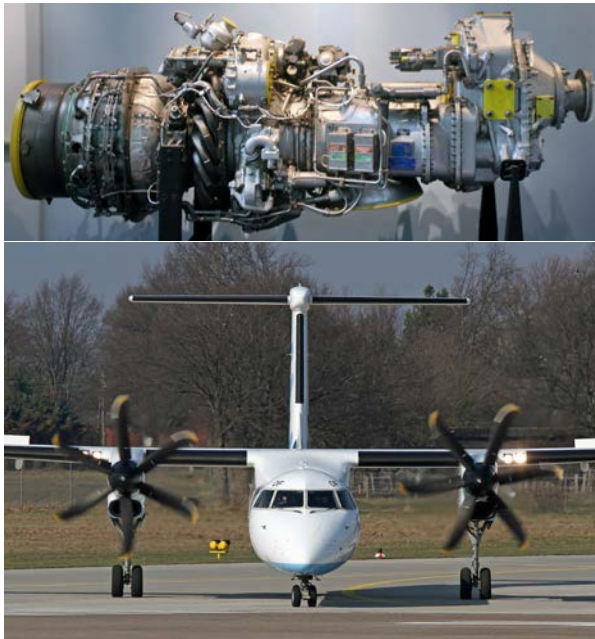
FIGURE 10.34 – Un turbopropulseur Pratt & Whitney Canada PWC123 équipant un Bombardier Dash 8 . Le PWC123 est configuré avec trois ensembles tournants concentriques, dont l'arbre moteur alimenté par une turbine libre, mais son agencement de principe reste similaire à celui décrit en figure 10.33.
