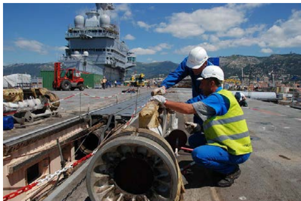
FIGURE 5.33 – Piston d'une catapulte à vapeur du porte-avions Charles de Gaulle.
