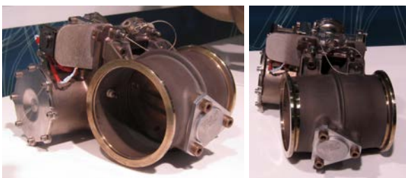
FIGURE 6.25 – Valve de régulation de l'écoulement d'air d'un ECS destiné à un Comac C919.
