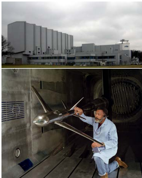
FIGURE 6.20 – Bâtiments de l'ETW ( European Transonic Windtunnel ) à Köln et veine d'essais de la National Transonic Facility de la NASA, de taille et capacités similaires.
