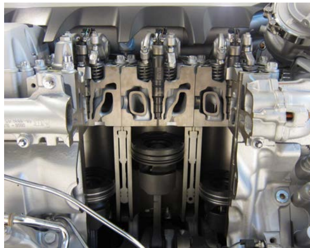
FIGURE 2.1 – Une découpe dans un moteur de camion laisse apparaître trois pistons dans leurs cylindres. Un système fermé est un bon outil pour étudier l'air emprisonné dans un cylindre. Le moteur photographié est un diesel MAN en V8.
