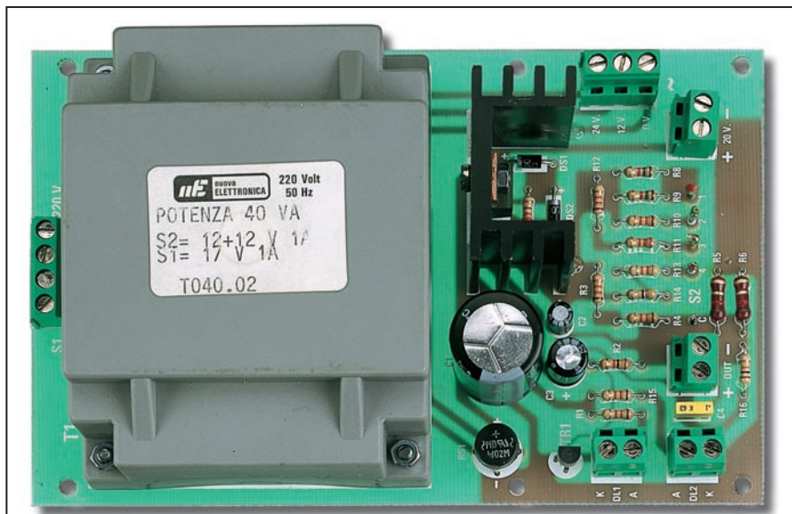
Figure 199 : Après avoir monté tous les composants sur le circuit imprimé et soudé leurs pattes sur les pistes en cuivre en dessous, vous obtiendrez un montage identique à celui de cette photo. Notez bien le radiateur de refroidissement sur lequel est fixé le circuit intégré IC1.
