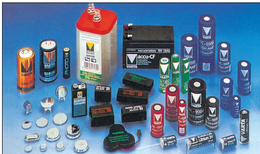
Fig. 37 : Dans le commerce, on peut trouver des piles de tensions et de dimensions diverses. La capacité d'une pile est exprimée en ampère/heure. Une pile de 3 Ah se décharge en une heure si l'on prélève 3 ampères, en deux heures si l'on prélève 1,5 ampère et en 30 heures si l'on prélève 0,1 ampère.
