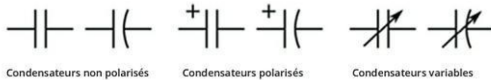
FIGURE 7-5 Symboles pour représenter les condensateurs.
