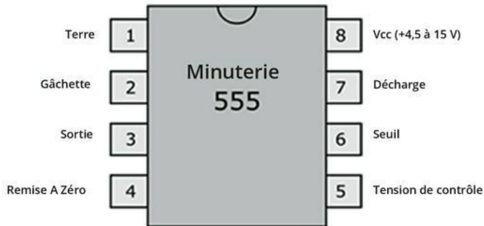
FIGURE 11-14 Brochage d'une minuterie 555.
