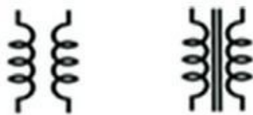
FIGURE 8-10 Symbolisation du transformateur à air et du transformateur à
