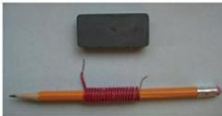
FIGURE 8-3 Le déplacement d'un aimant à l'intérieur d'une bobine de fil métallique induit un courant dans le fil.
