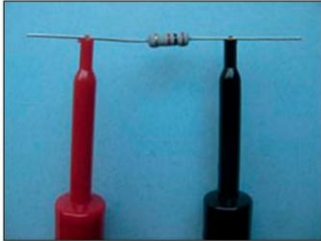
FIGURE 5-9 À l'aide de votre multimètre, mesurez la valeur réelle d'une résistance fixe (en ohms).
