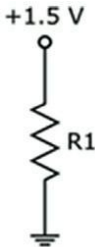
FIGURE 14-5 Une façon plus simple de représenter les connexions entre une pile et une résistance.
