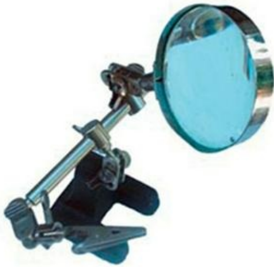
FIGURE 13-4 Une troisième main garnie de pinces et d'une loupe.
