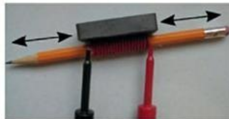
FIGURE 8-3 Le déplacement d'un aimant à l'intérieur d'une bobine de fil métallique induit un courant dans le fil.
