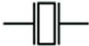
FIGURE 8-9 Ce symbole, en schématique, représente un cristal.
