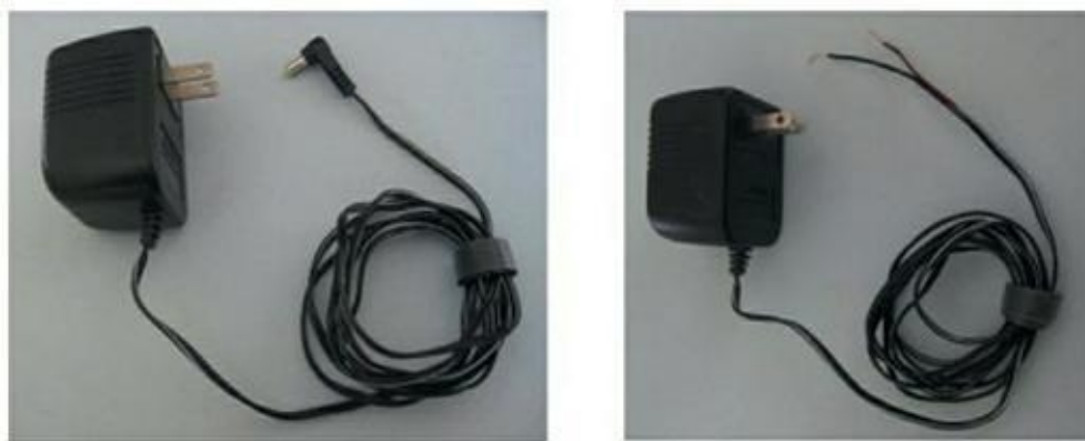
FIGURE 12-6 Cet adaptateur transforme le courant alternatif de 120 volts en courant continu de 7,5 volts et fournit jusqu'à 300 mA. J'en ai modifié la
