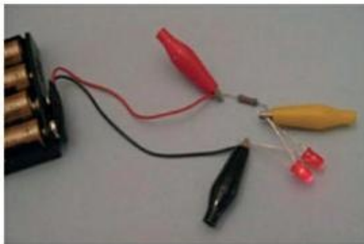
FIGURE 4-4 Deux manières d'assembler le circuit des deux LED branchées en parallèle.
