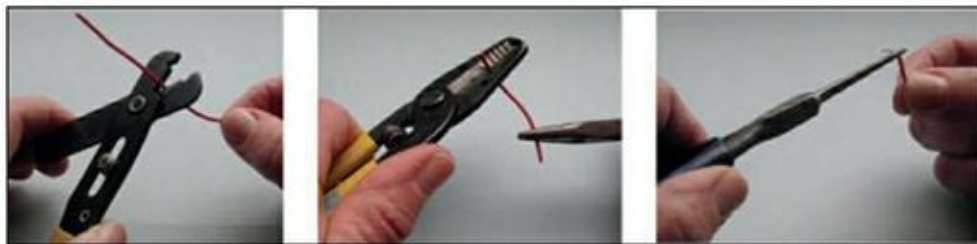
FIGURE 15-5 Couper, dénuder et tordre un fil d'interconnexion.
