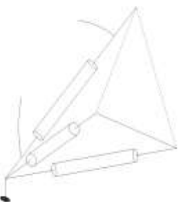
Figure 7.12. Console à bras isolant avec deux isolateurs à compression - Perspective
