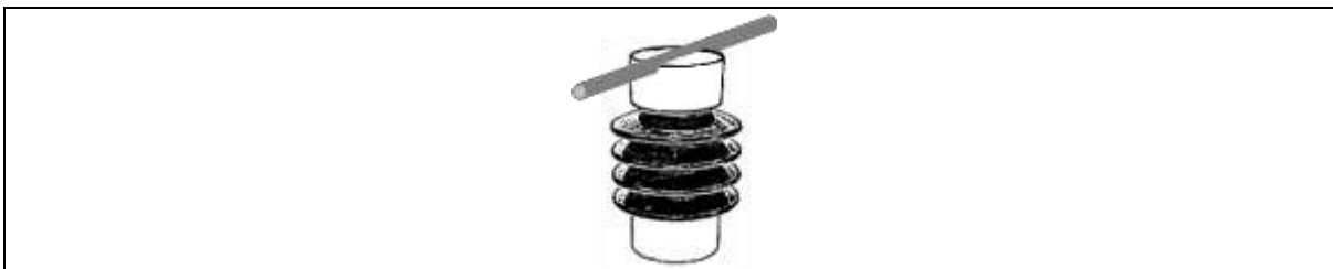
Figure 5.39. Modes de pose des canalisations électriques – Sur des isolateurs
